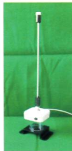
開発された 葉面積評価センサ
